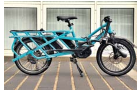
Kompakt und klein: Der Sattel lässt sich weit nach unten stellen, der Lenker abknicken.
