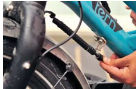
Die Rückholfeder stabilisiert das Lenken. Zum Falten ist sie herausnehmbar.
