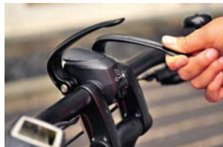
Variabler Vorbau: So sitzen Menschen von 150 bis 195 Zentimeter Größe angenehm.
