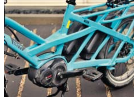
Antriebseinheit in der Mitte: der Bosch „Performance“. Dahinter ein oder auch zwei Akkus.
